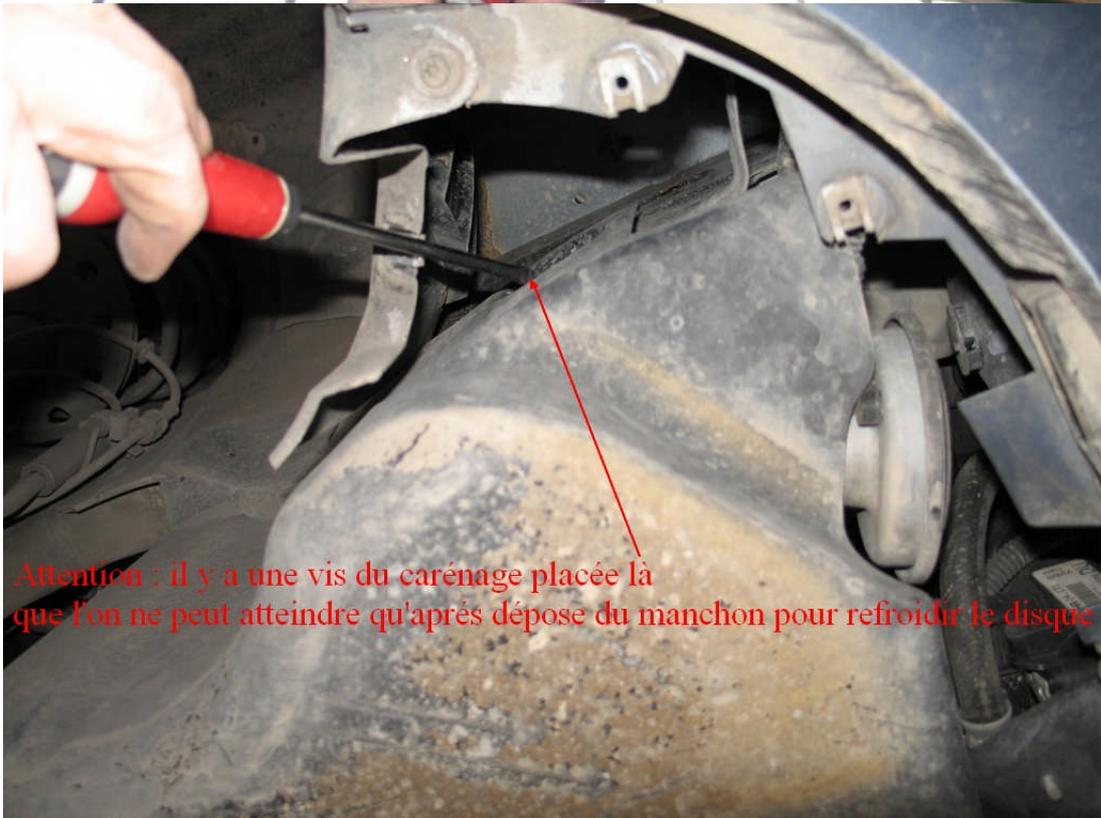
Attention : il y a une vis du carénage placée là que l'on ne peut atteindre qu'après dépose du manchon pour refroidir le disque
