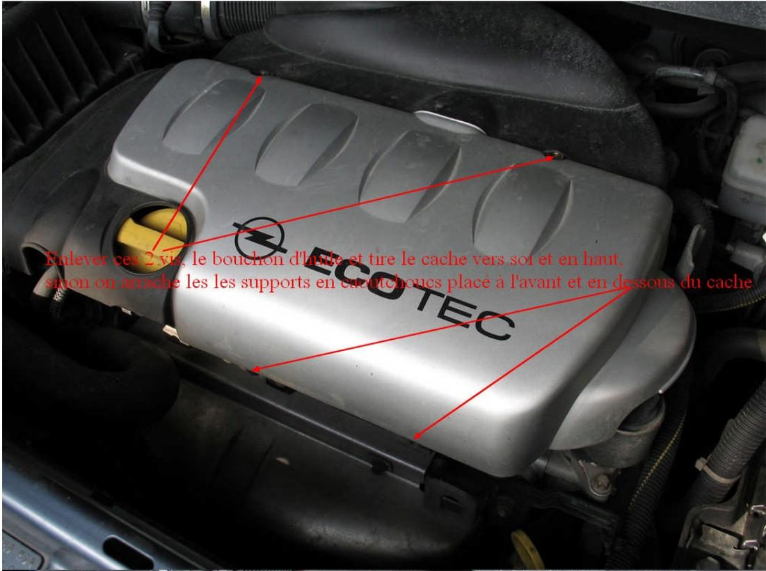
Enlever ces 2 vis, le bouchon d'huile et tire le cache vers soi et en haut, sinon on arrache les supports en caoutchoucs placé à l'avant et en dessous du cache
