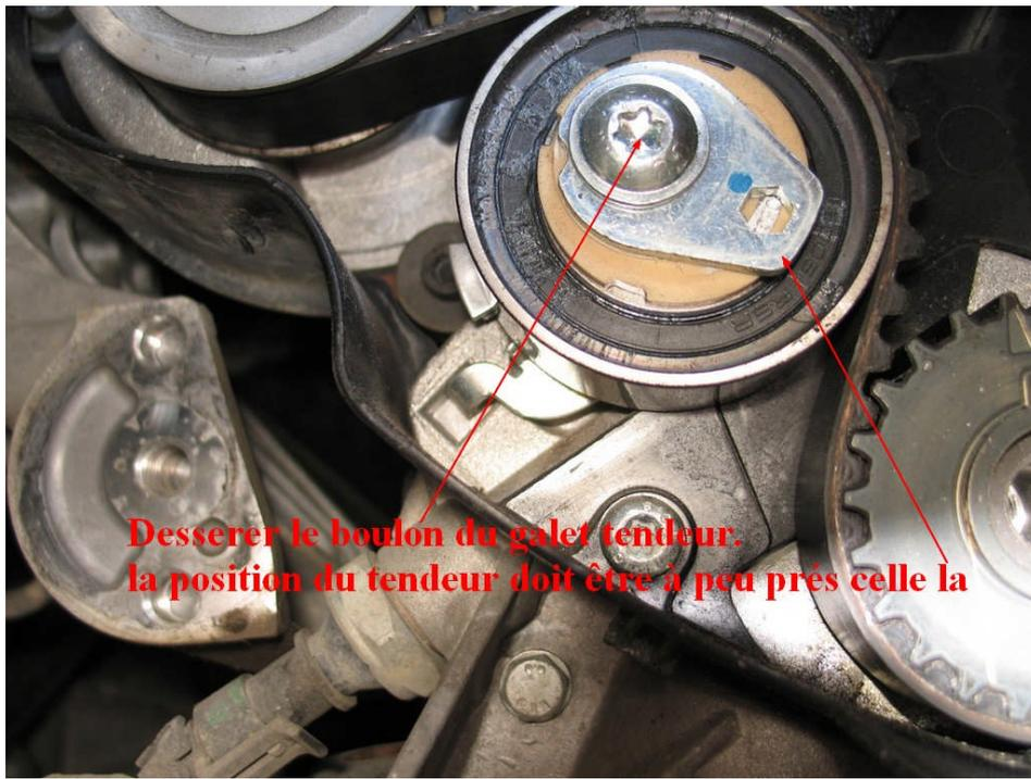
**17 Tourner le galet tendeur dans le sens horaire jusqu'à ce que le curseur soit à la butée gauche, utiliser une clé Allen**
