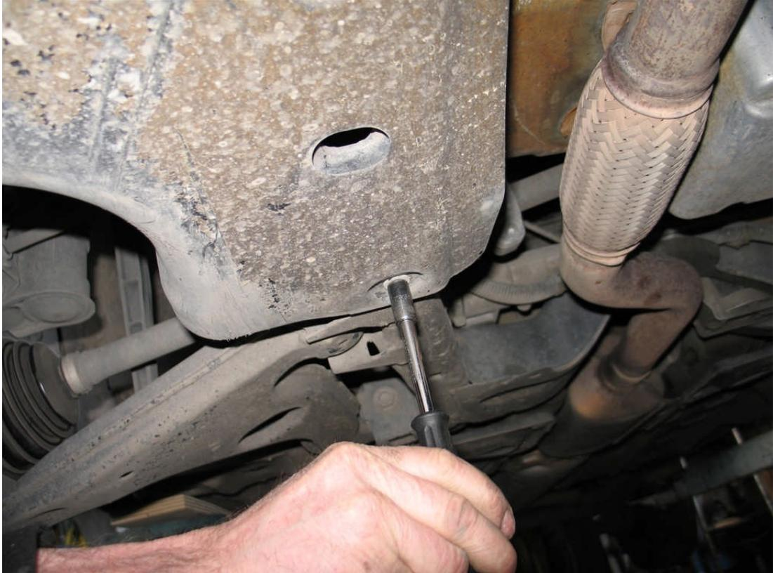
Déposer la prise d'air pour refroidir le disque de frein et atteindre la dernière vis du carénage
